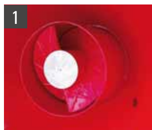
▶ Vis de poussée sortie de tunnel, avec pales d'usure interchangeable
